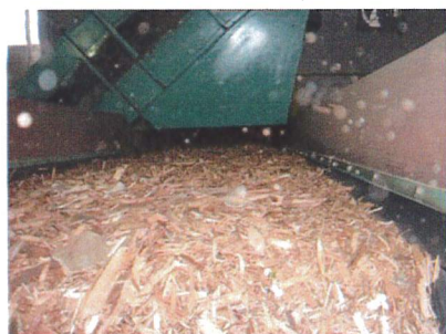
処理前の原料 (振動コンベヤ部)
