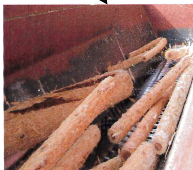
ローリングバーカー内部
